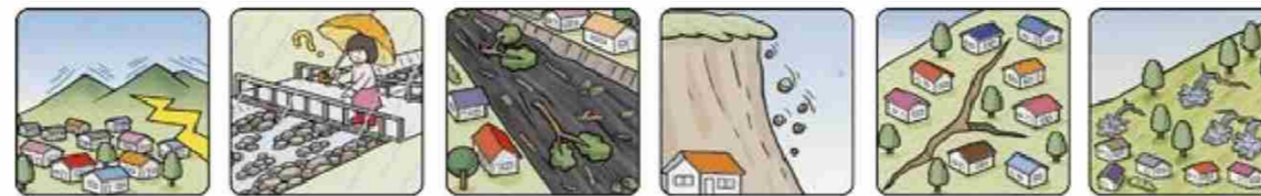
山鳴りがする 雨が降り続けているのに川の水位が下がる 川の流が濁り流水が混ざり始める 小石がバラバラ落ちてくる 地面にひび割れができる 斜面から水がふき出す
