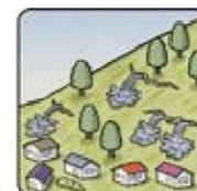
斜面から水がふき出す
