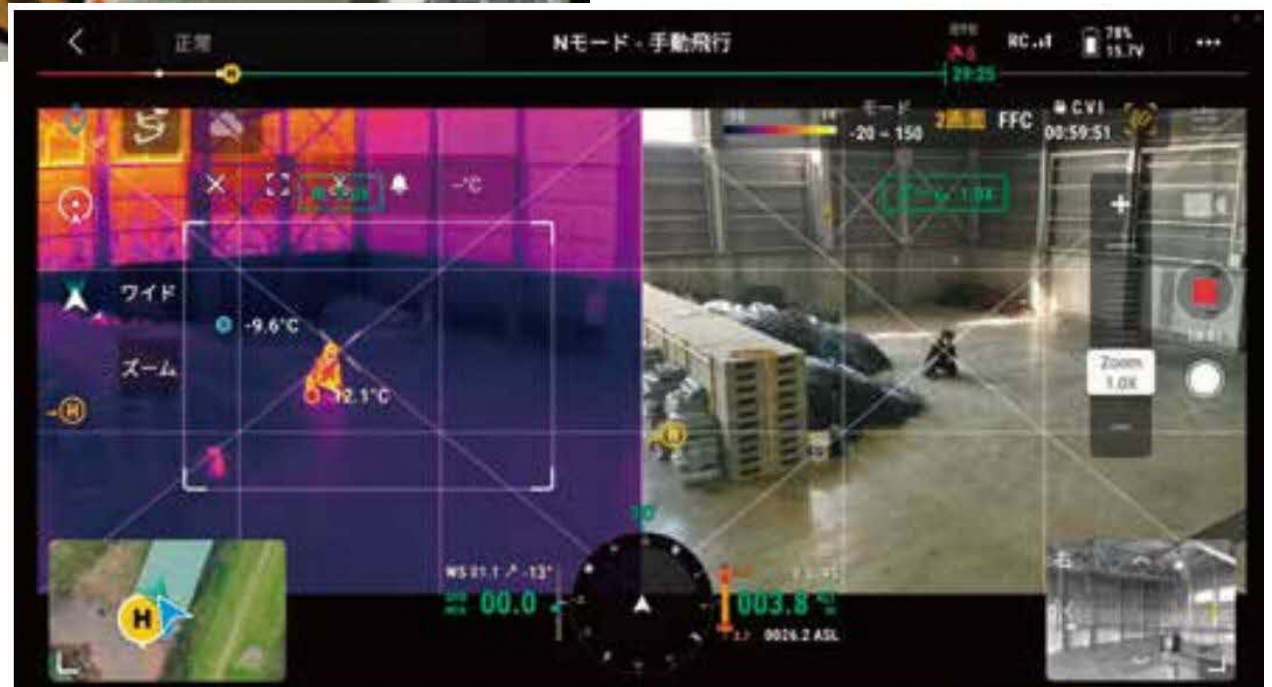
ヒグマ役をドローンで発見した際の画像。画面には高度などの各種情報が表示され、対象物の温度も把握できます。
