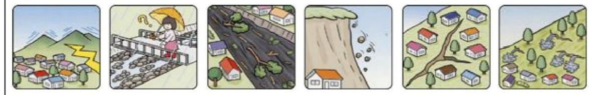
山鳴りがする 雨が降り続けているのに川の水位が下がる 川の流れが濁り流水が混ざりはじめる 小石がバラバラ落ちてくる 地面にひび割れができる 斜面から水がふき出す
