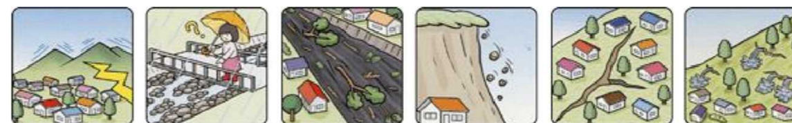
山鳴りがする 雨が降り続けているのに川の水位が下がる 川の流れが濁り流水が混ざりはじめる 小石がバラバラ落ちてくる 地面にひび割れができる 斜面から水がふき出す
