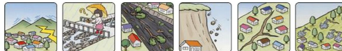
山鳴りがする 雨が降り続けているのに川の水位が下がる 川の流が濁り流水が混ざりはじめる 小石がバラバラ落ちてくる 地面にひび割れができる 斜面から水がふき出す
