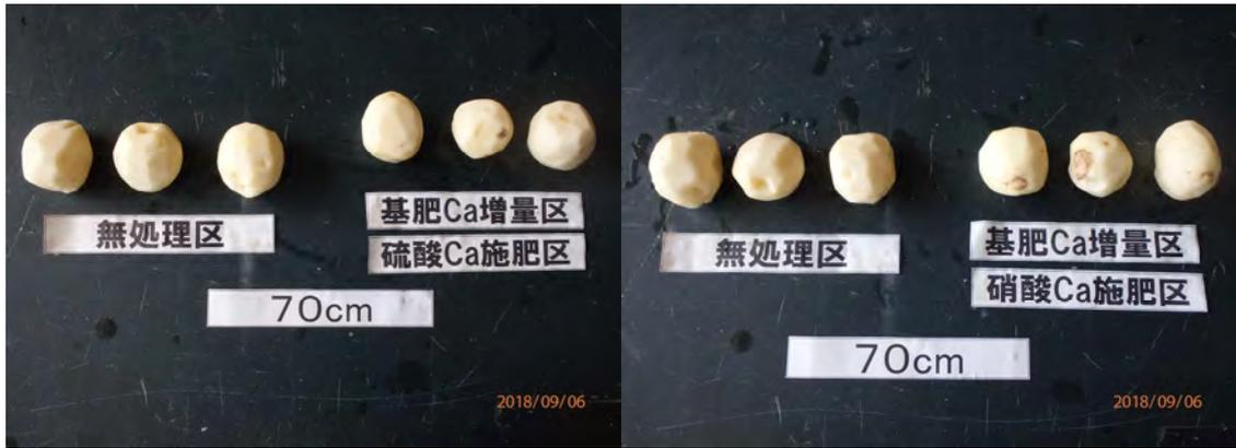
写真1 70cmの高さから落下させた馬鈴薯
