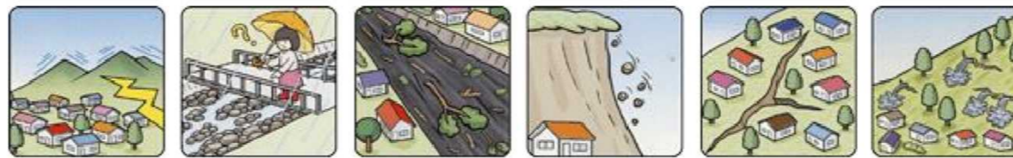
山鳴りがする 雨が降り続けているのに川の水位が下がる 川の流れが濁り流水が混ざりはじめる 小石がバラバラ落ちてくる 地面にひび割れができる 斜面から水が吹き出す
