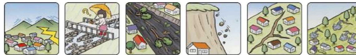
山鳴りがする 雨が降り続けているのに川の水位が下がる 川の流りが濁り流水が混ざりはじめる 小石がバラバラ落ちてくる 地面にひび割れができる 斜面から水がふき出す
